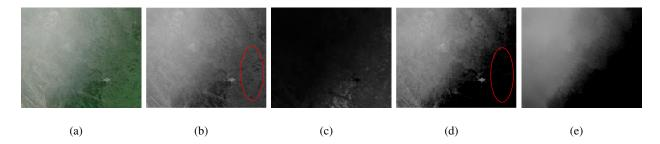
Fig. 2. Haze Distribution Map of a hazy image. (a) Hazy image. (b) Raw HDM. (c) Saturation map. (d) Corrected HDM. (e) HDM
